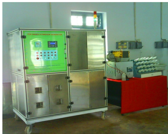
5kW PEM Cell
